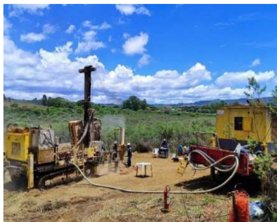
Foto 11 Operação de sondagem RC Autor: Viridis, 2024
